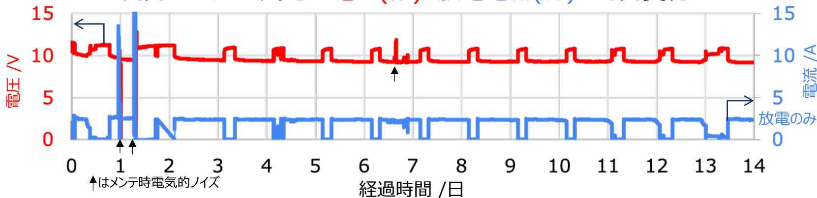
1次側：亜鉛空気電池電圧(赤)と放電電流(青)の時間変化
