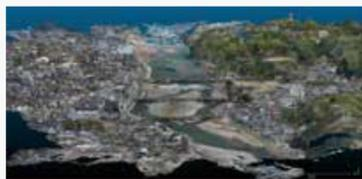
ドローンで災害現場の正確な地理空間情報を取得することで、地形の変化や被害状況を立体的に可視化します。これにより、建物の損傷状況やインフラ施設の崩壊箇所等を正確に把握できるようになります。
